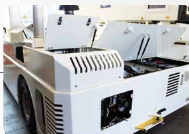
Leicht zugängliche Wartungs- und Notbedienungskappen
