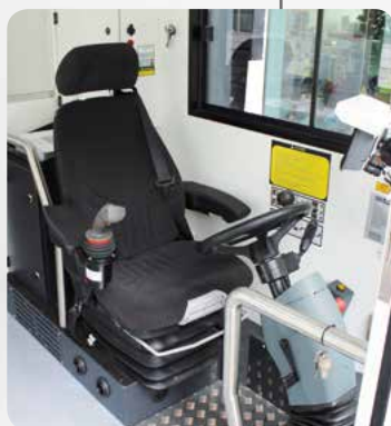
Fahrerstand mit luftgefedertem Komfort- Sitz, Joystick und Color- Touchscreen
