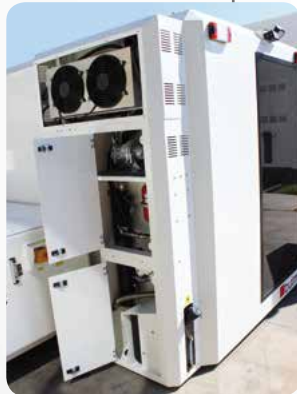
starke, auf Dauerbetrieb ausgelegte Stand- heizung und Klimaanlage
