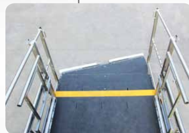
ausfahrbare Frontplattform mit Drehzunge und Einschwenk- sowie teleskopierbare Seitengeländern
