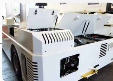
trappes d'entretien et fonctions de secours aisément accessibles
