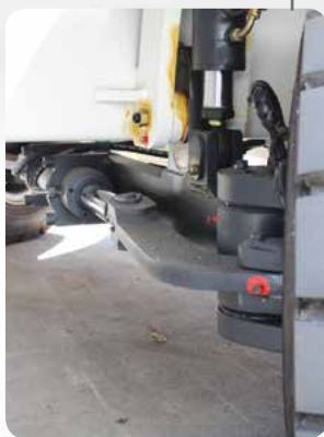
robuste essieu directeur de chariot élévateur latéral avec angle de braquage à près de 90°
