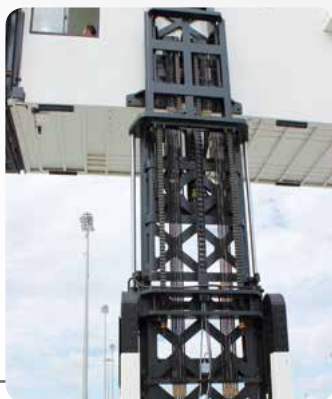
mât de levage Triplex - tous les composants porteurs avec marge de sécurité décuplée
